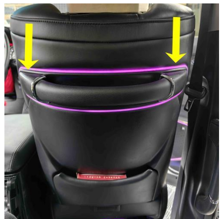
9.将黄色箭头处饰板撬开，此位置两颗螺丝，安装上我司灯具。
