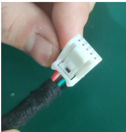
2.找到方向盘下方五孔的插头，对接我司埃尔法主控电源线上插头
